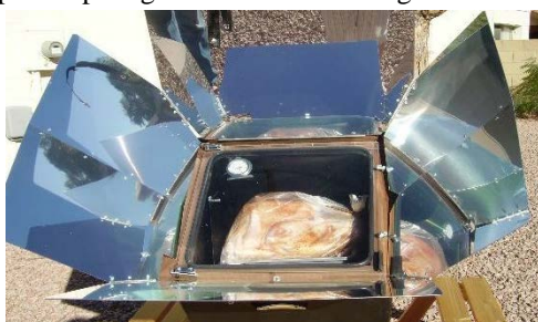
Figura 35: Os fornos solares aproveitam o calor do sol para cozinhar, especialmente em zonas remotas.
