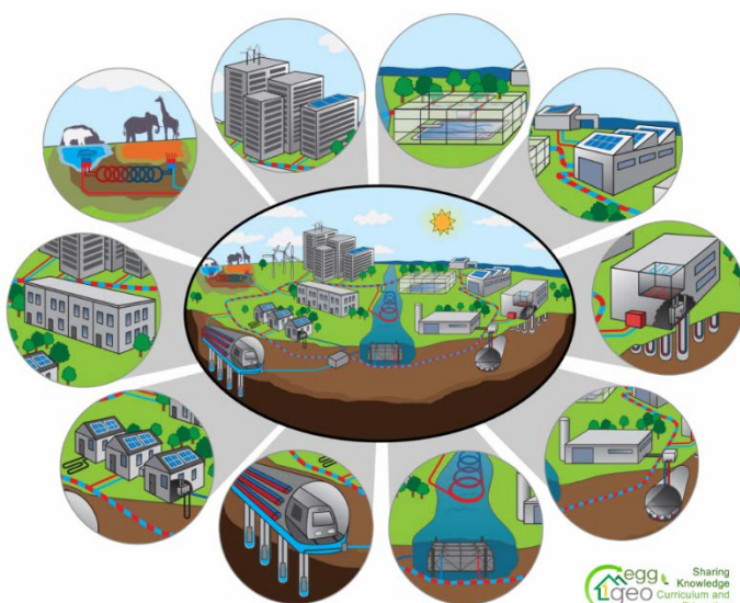
Figura 85: A energia geotérmica é utilizada diretamente para aquecimento, agricultura e turismo, e indiretamente para geração de eletricidade, dependendo da temperatura da fonte 117 .
