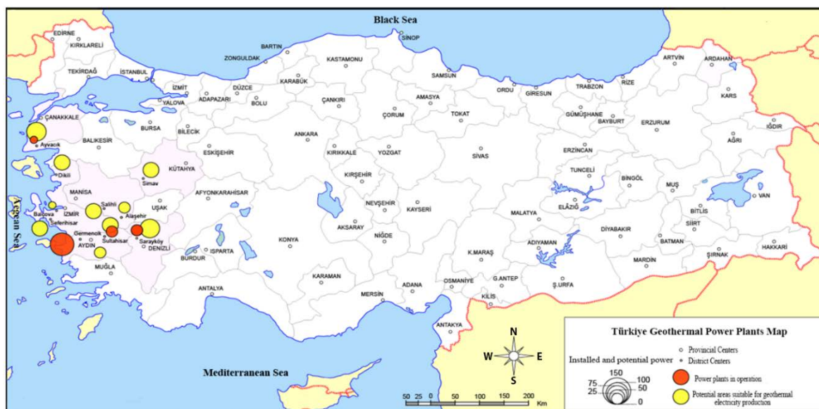
Figura 81: A Turquia ocupa o 4.º lugar a nível global na eletricidade geotérmica, com uma capacidade de 1.734 MW, concentrada principalmente na região do Mar Egeu.
