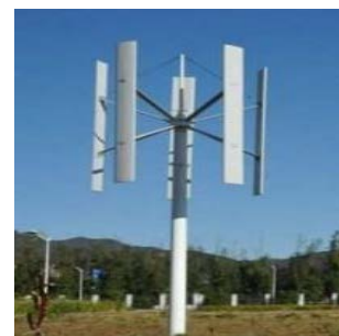
Figura 67: As turbinas eólicas de eixo vertical podem captar vento de qualquer direção e são adequadas para aplicações urbanas ou de pequena escala.
