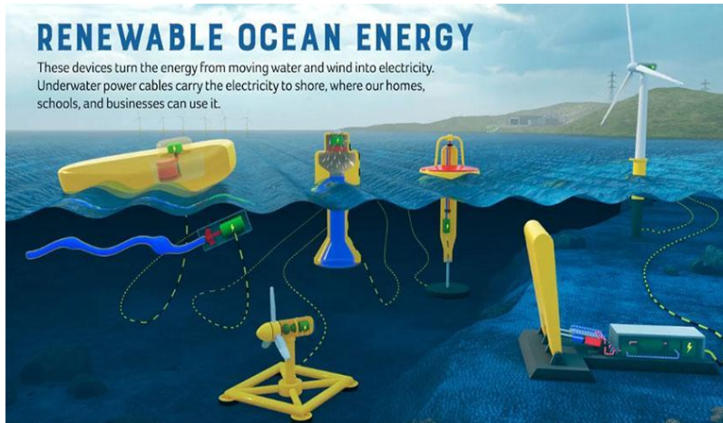
Figura 92: Os sistemas de energia oceânica aproveitam a energia das ondas, marés e correntes para gerar eletricidade, utilizando cabos subaquáticos para a entregar à costa 125 .
