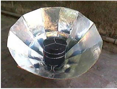
Figura 40: Os fornos solares utilizam refletores parabólicos para concentrar a luz solar para cozinhar e aquecer.
