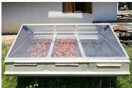
Figura 48: Os secadores solares utilizam ar aquecido para secar os produtos agrícolas, de forma natural e eficiente.
