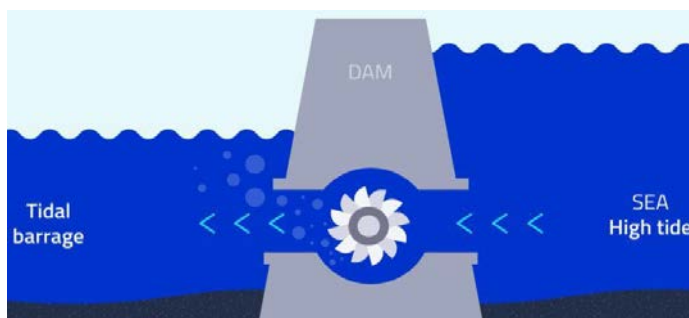
Figura 101: Os movimentos das marés são convertidos em energia elétrica através de turbinas, constituindo-se como fonte de energia renovável.
